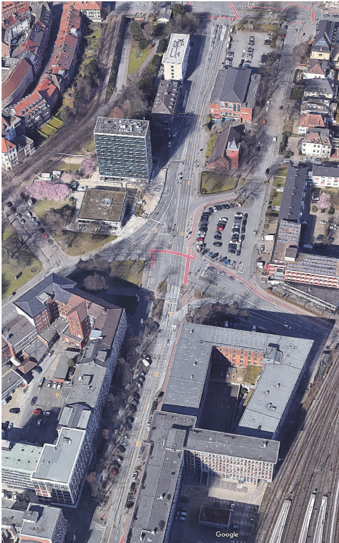
Bahnhofstraße: Ohne den MIV genügend Platz für Busspuren in Mittellage und den Radverkehr (südwärts auf der Westseite, in zwei Richtungen auf der Ostseite bis zum Hbf)
