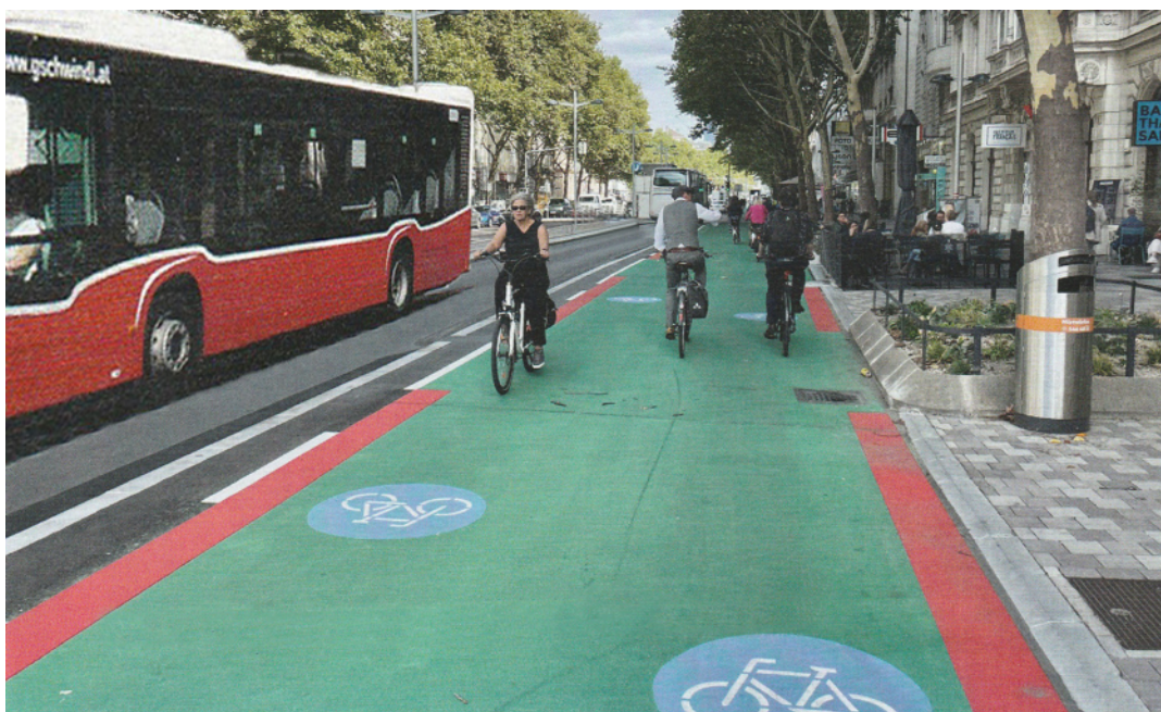
Impression: Zweirichtungs-Radweg in der Bahnhofstraße (Ostseite) neben Busspur südwärts
