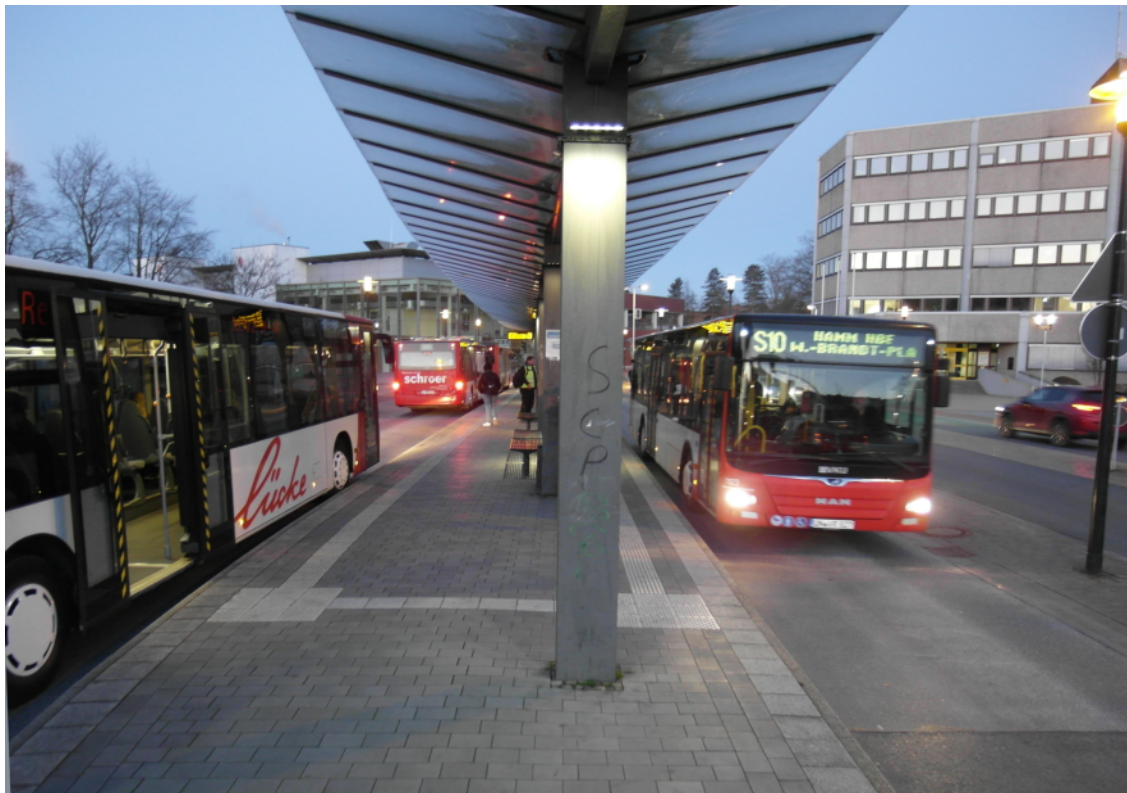
Beispiel für Haltestelle in Mittellage (BusPort) mit kurzen Wegen und geringem Zeitverlust für Umsteigende. Bei diesem Beispiel zu geringe Breite und zu wenig Witterungsschutz
