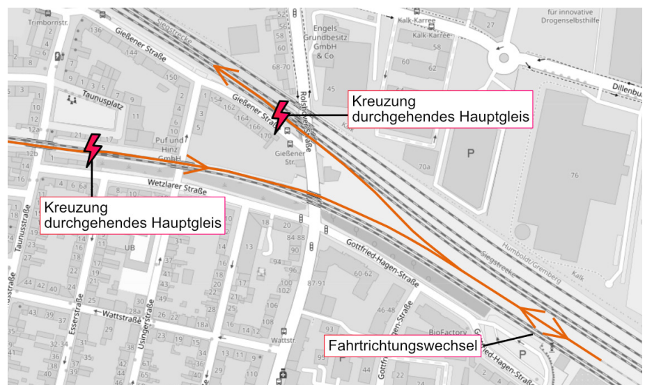
In Köln Kalk muss ein Fahrtrichtungswechsel stattfinden. Es kann nicht ein- oder ausgestiegen werden. Bei der Fahrt Richtung Köln Hbf muss die stark befahrene Strecke Köln Hbf – Troisdorf gekreuzt werden.
